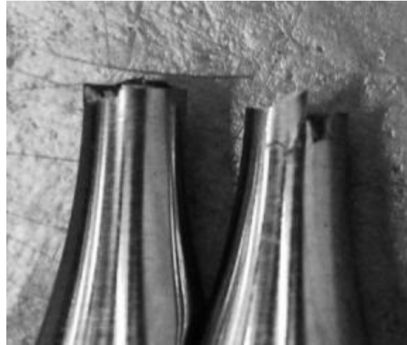
Fig. 12. Aspecto da falha de corpo de prova para tensão média, 250 Mpa.
